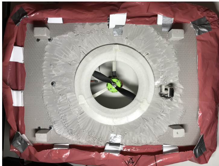
Obr. 18: Zajištění funkčnosti pláště pomocí třmenů z izolepy
