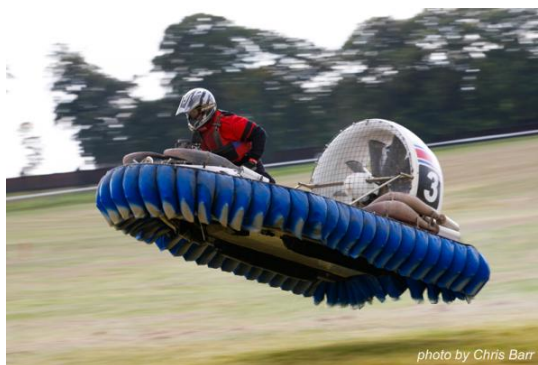
Obr. 4: Segmentové provedení pláště pro závodní vznášedla [4]
