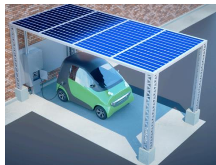
Obrázek č.11 - Návrh fotovoltaické stanice [29]
