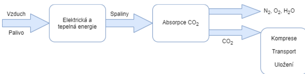
Obrázek 2: Schéma Post-combustion technologie
