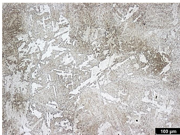
Obrázek 22: Výchozí struktura nástrojové oceli 55NiCrMoV7 dodavatele B, Nital 2%
