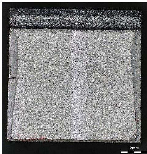
Obrázek 34: Lomová plocha vzorku dodavatele B, popuštěno 500 °C / dusík 3 bary, světelná mikroskopie
