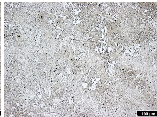
Obrázek 23: Struktura nástrojové oceli 55NiCrMoV7 dodavatele B po žíhání na měkko (690 °C / 2 hod.), Nital 2%
