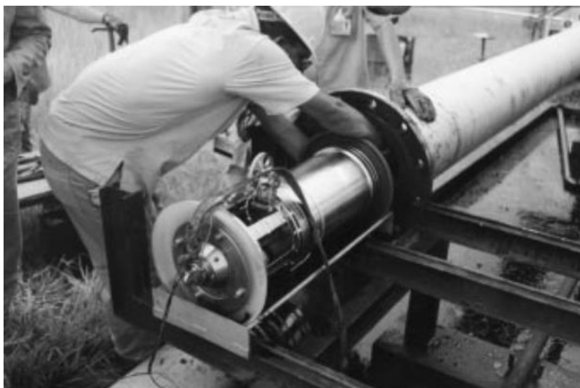
Obrázek 8 - "prase" je vkládáno do potrubí pro test [7]
