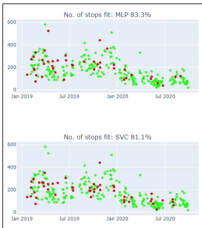
Obrázek 26: Úspěšnost predikce MLP a SVC algoritmů pro počet krátkých zastávek druhé stroje výrobní linky. Zeleně – správně predikované hodnoty, Červeně – chybně predikované hodnoty
