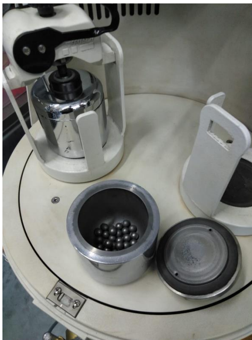
Obrázek 12: Mlecí komora s nádobami a kuličkami z WC+Co
