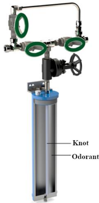
Obrázek 19 Knotový odorizér Welker FTO – převzato, upraveno [17]
