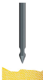
Obr. 3.: Konstrukce sondy s jednoduchým sáním [5]
