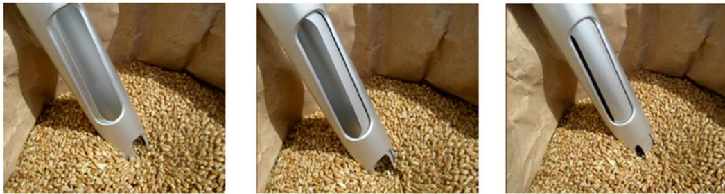
Obr. 2.: Princip ručního odebrání vzorku [3]
