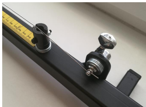
Obr. 4.3 Detail struny s ladící mechanikou
