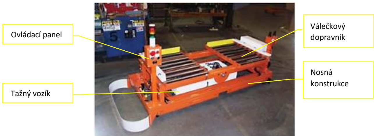
Obr. 9.: Automaticky řízený vozík s přidaným válečkovým dopravníkem [4]
