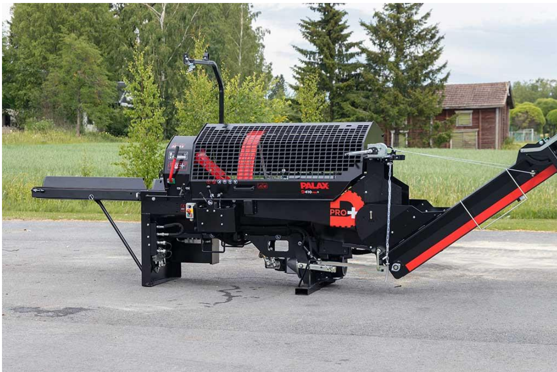
Obr. 4 – Štípací automat Palax [10]
