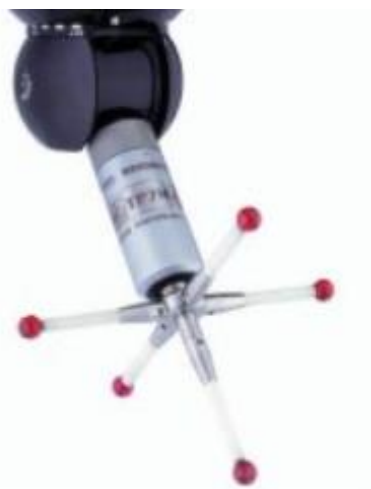
Obrázek 7 - Ukázka sondy s více dotykovými členy [17]
