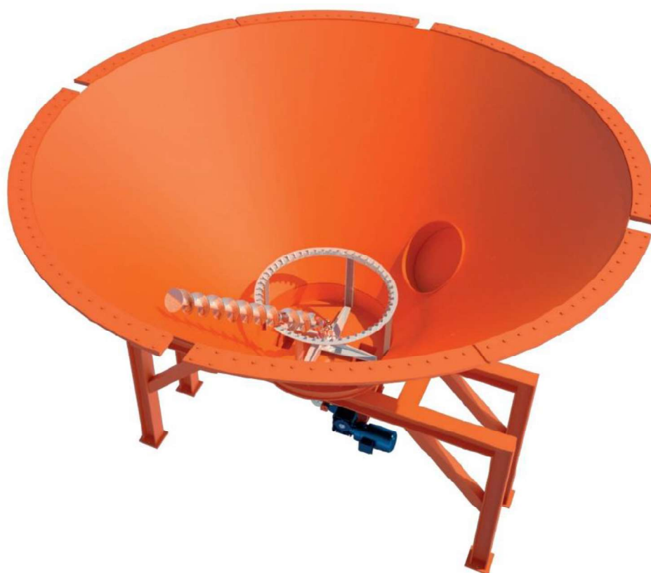
Obrázek 21: Šnekový vyprazdňovací systém síla pro piliny a štěpku [43]
