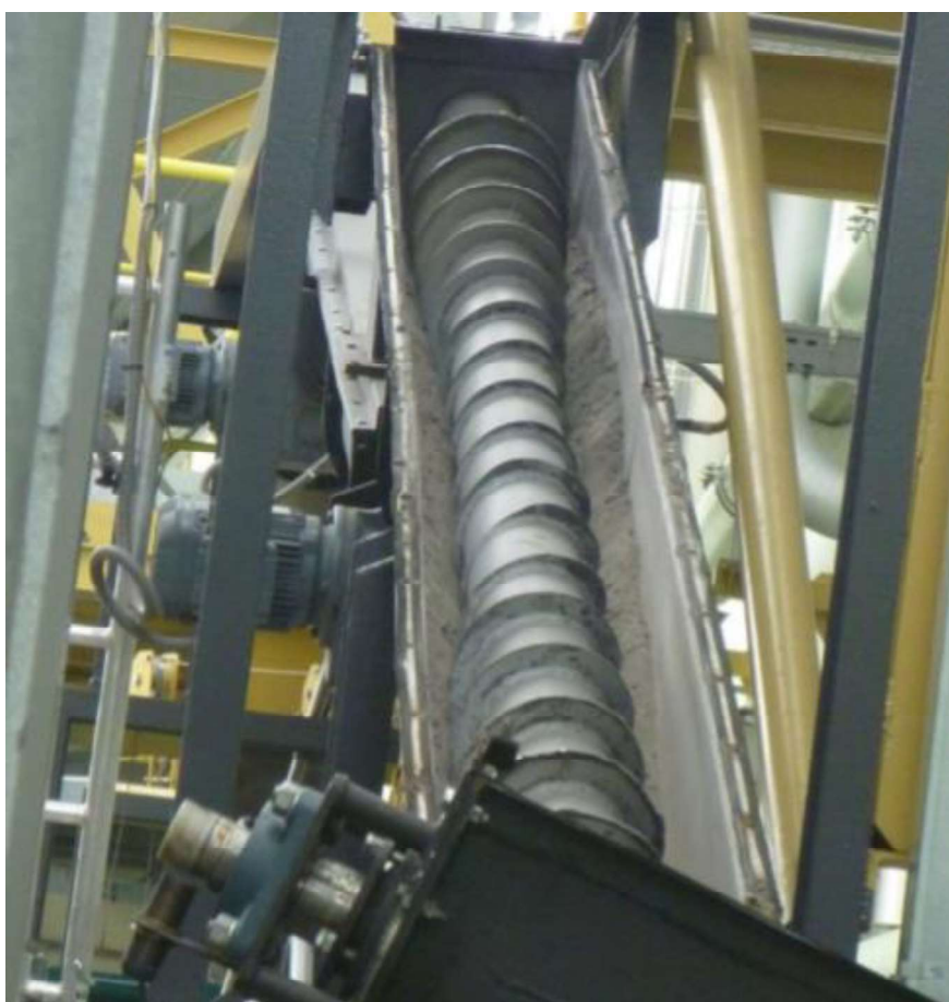
Obrázek 32: Opatřebený šnek odpopelnění – Teplárna Mydlovary, 9 MWt [29]
