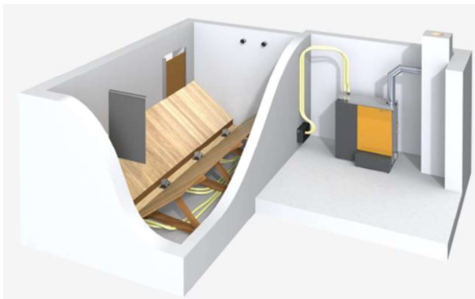
Obrázek 26: Sklad pelet s podtlakovým sacím systémem [31]
