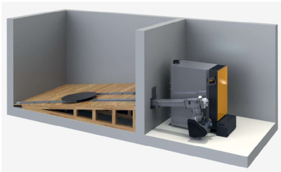
Obrázek 19: Nakloněné dno skladu štěpky pro možnost vynesení veškerého paliva [12]
