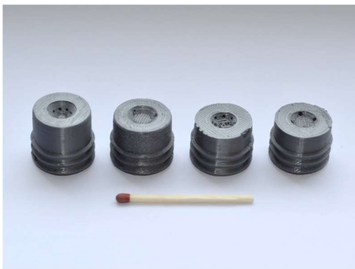
Obrázek 30 Výběr z prototypů vyvíjené 3/4" trysky [autor]
