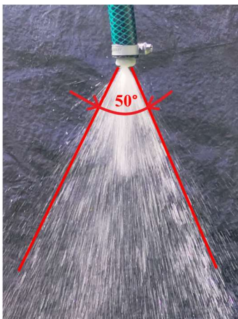
Obrázek 31 Zkouška modelu finální geometrie navrhované trysky [autor]
