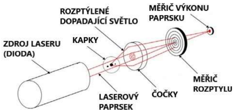
Obrázek 14 Schéma principu fungování měřiče částic Malvern Spraytec , upraveno [15]
