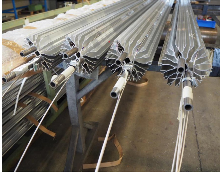
Obr. 9: Ukázka svazku trubek se žebrováním latentního uložiče LH-TES [10]
