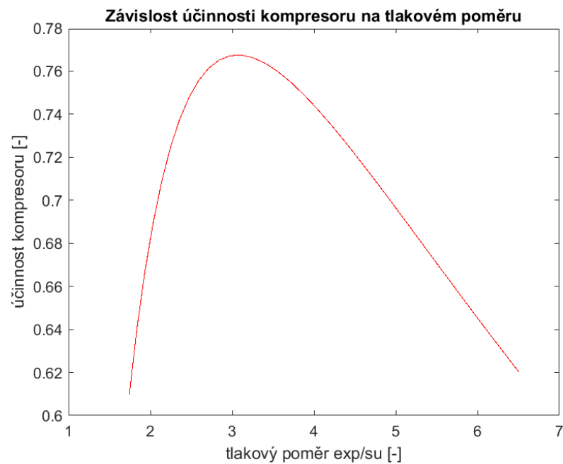
Obr. 35: závislost účinnosti kompresoru na tlakovém poměru
