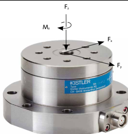
Obrázek 30 Znárodnění směrů měřených složek dynamometru Kistler 9272 [38]
