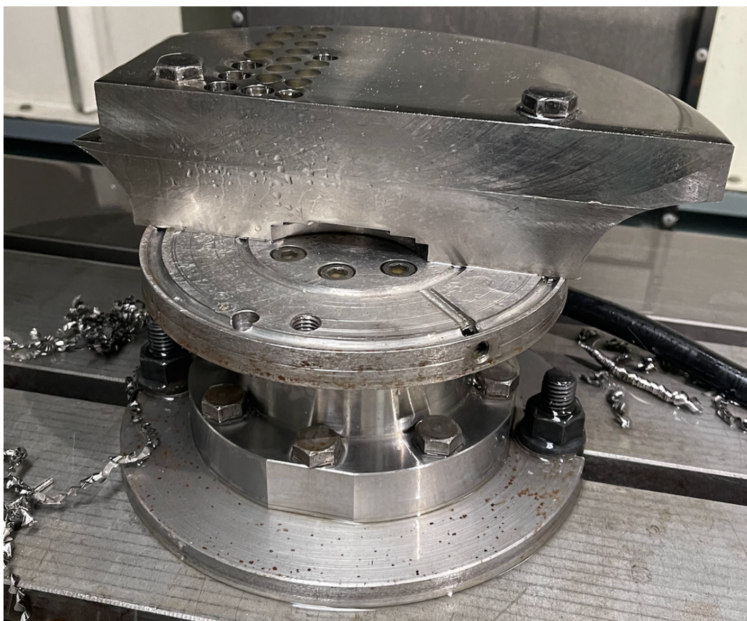
Obrázek 26 Obrobek upnutý v dynamometru
