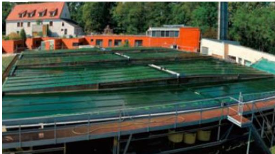
Obr. 3 Kaskády nakloněných ploch s filmovou vrstvou média [2]
