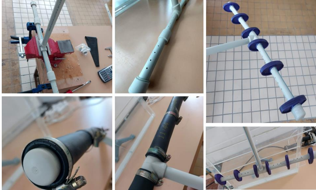
Obr. 27 Fotky z výroby a montáže dvou variant aeračních elementů
