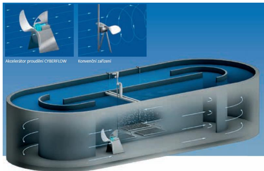
Obr. 14 Kombinovaný systém pomocí akceleratoru a povrchové aerace [16]
