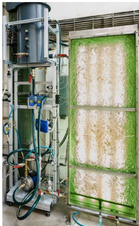
Obr. 6 Deskový fotobioreaktor v laboratořích FS ČVUT v Praze.
