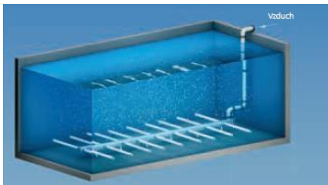
Obr. 12 Středobublinný systém TEX-FLEX společnosti KUNST [16]
