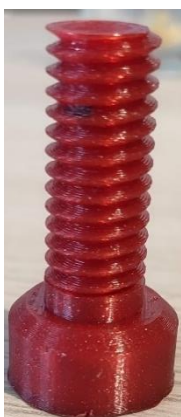
Obrázek 27 Protikus s vnějším závitěm (foto: autor)
