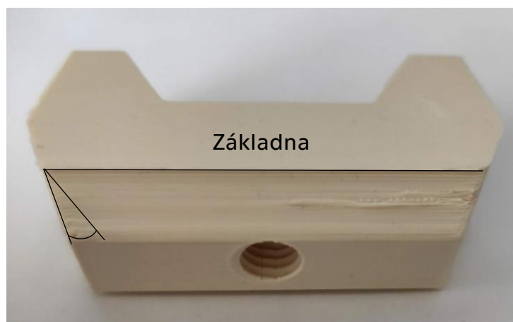
Obrázek 21 Propad stěny modelu (foto: autor)
