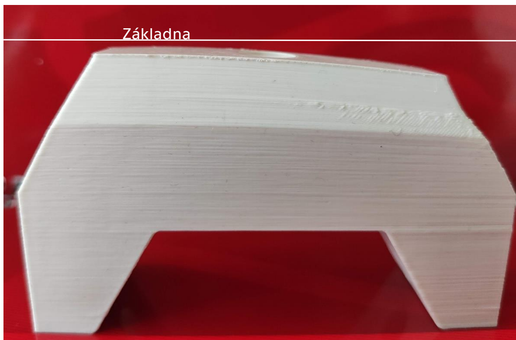
Obrázek 22 Posunutí vrstev vlivem odlepení od podložky (foto: autor)
