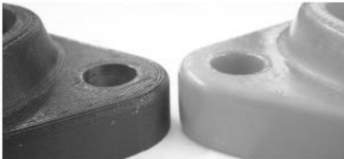
Obrázek 16 Vyhlazování ABS v acetonových výparech (Kuczko, 2017)
