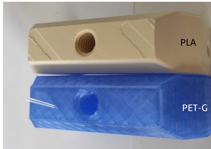
Obrázek 28 Porušení první vrstvy výtisku (foto: autor)
