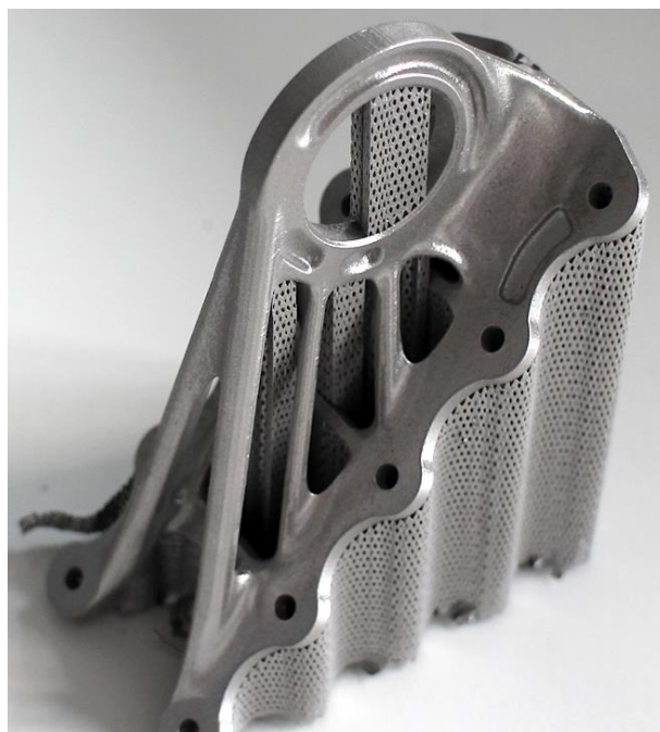
Obrázek 9 DMLS výtisk s podporami (Varotsis, 2021)
