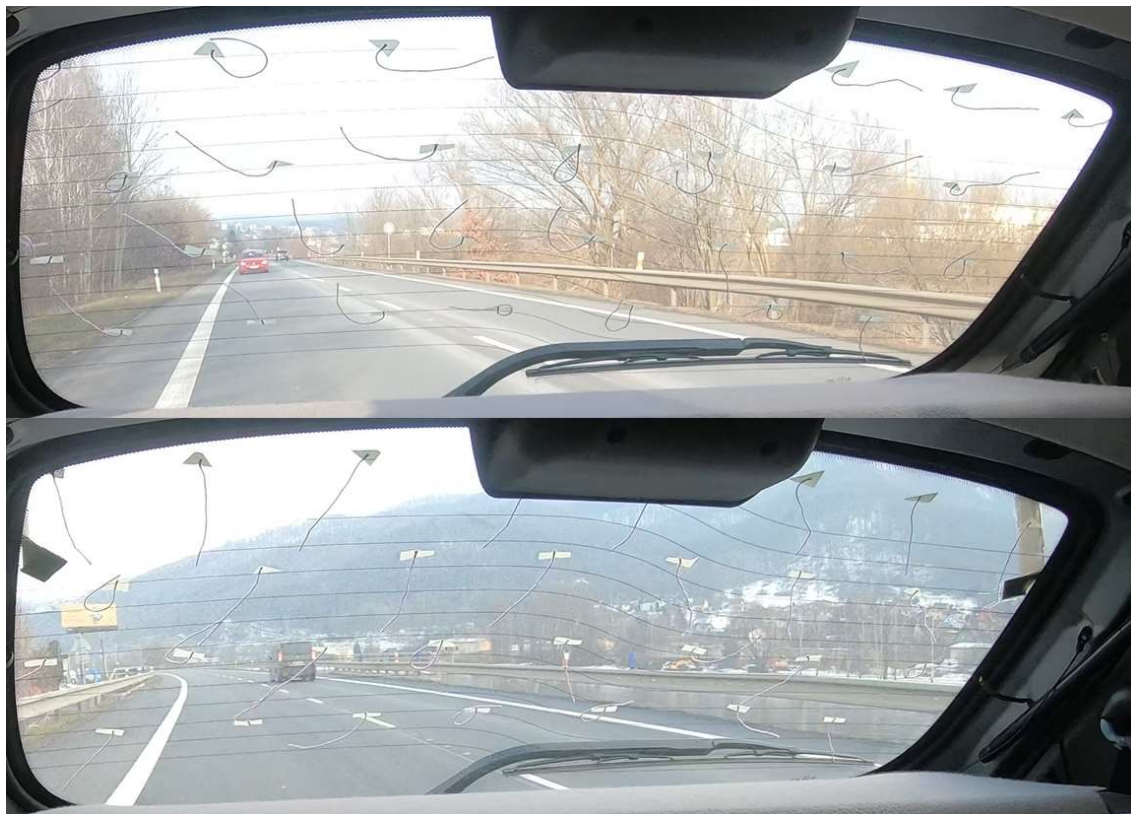
Obrázek 7: Vizualizace proudění provázky před a po použití spoileru pátých dveří [13]
