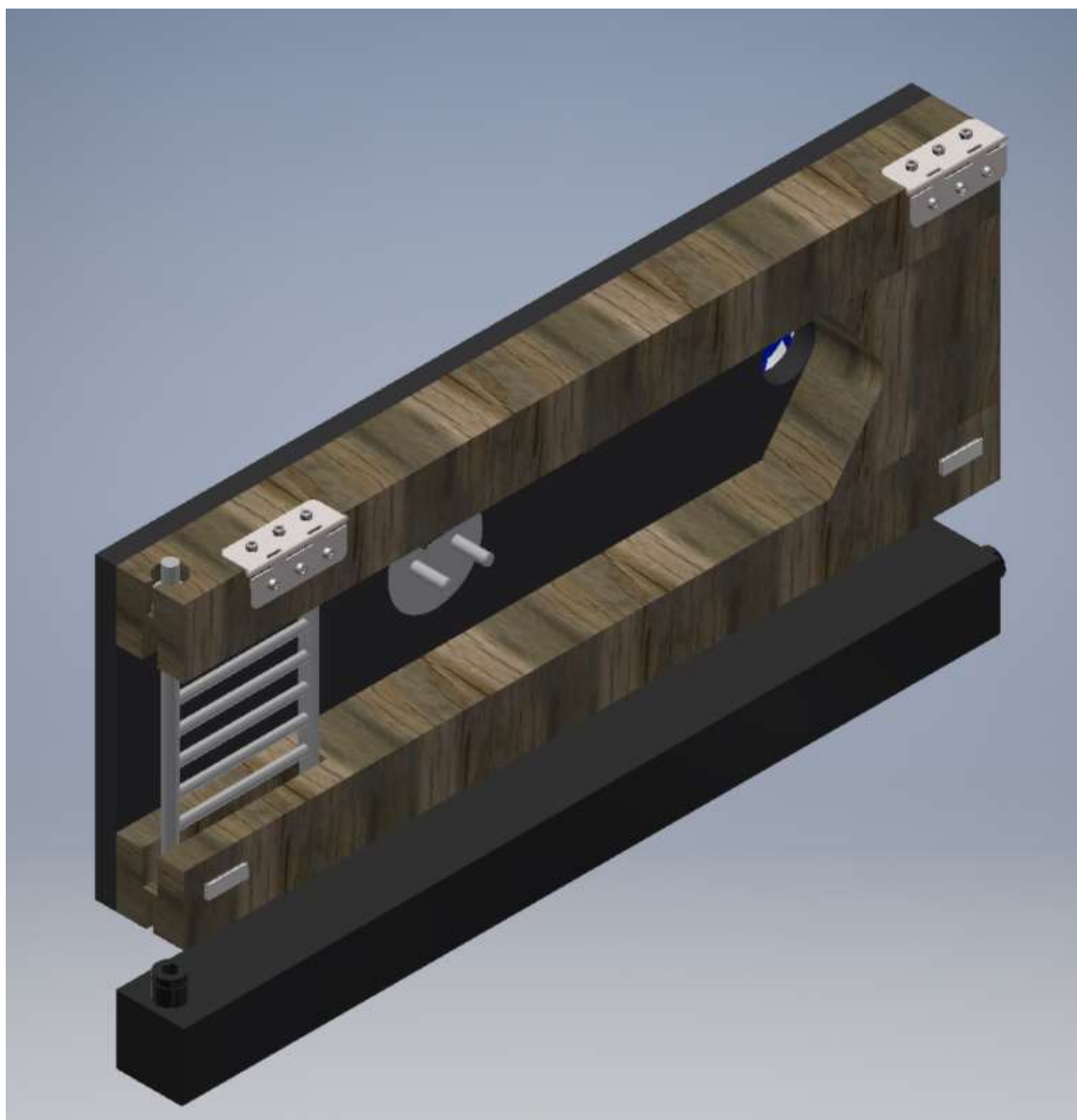
Obrázek 10: Tělo tunelu s komponenty pro výměnu modelu, hřebenem, zásobníkem kouře a ventilátorem
