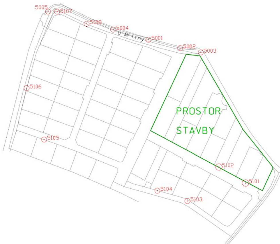
Obrázek 9 - Schéma vytyčovací sítě a označení prostoru celé stavby
