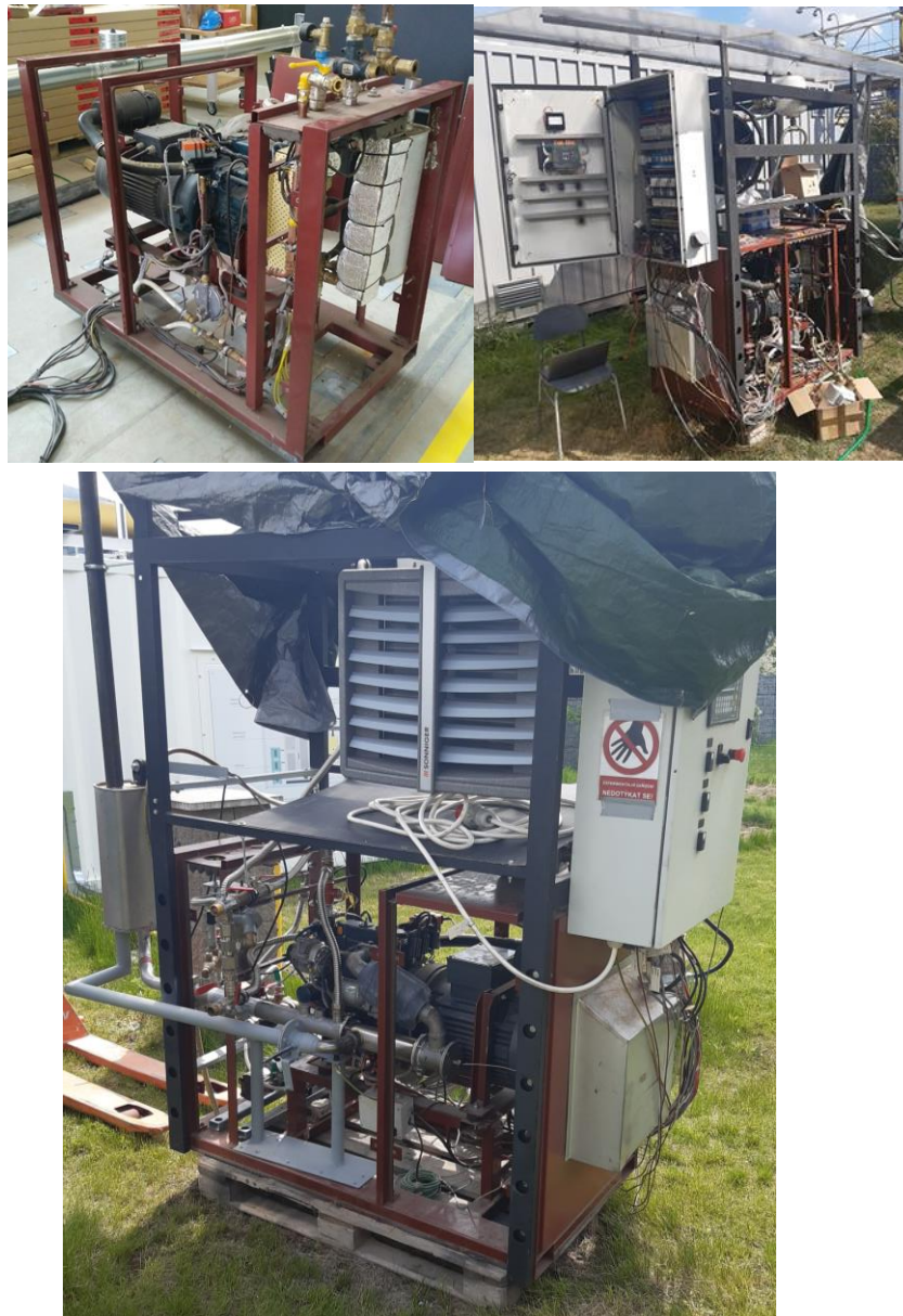
Obrázek 54: Různé verze okruhů odvádějících teplo z ICE během experimentálního vývoje ICE+ORC
