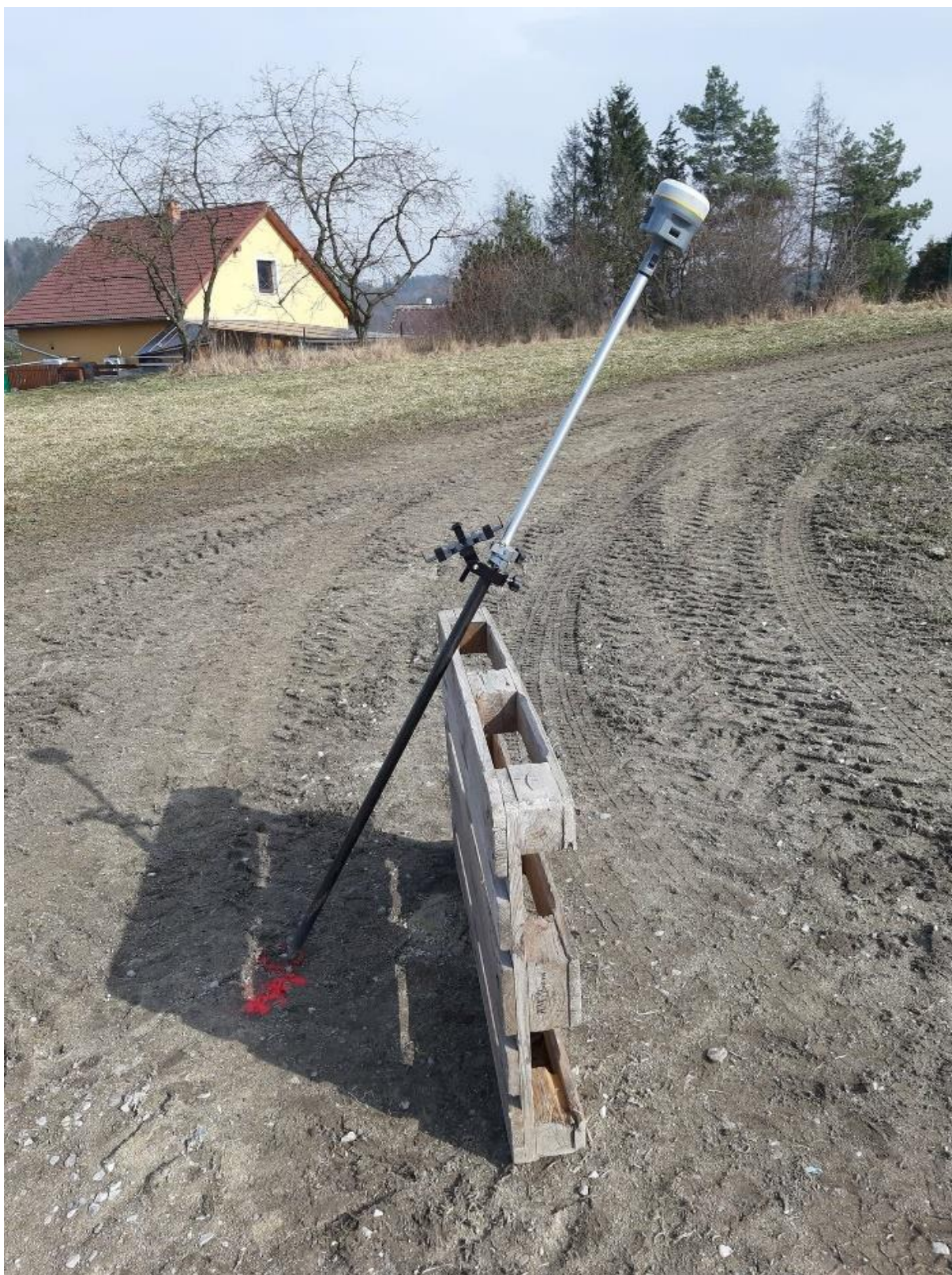
Obr. 9 GNSS přijímač s náklonem 30°
