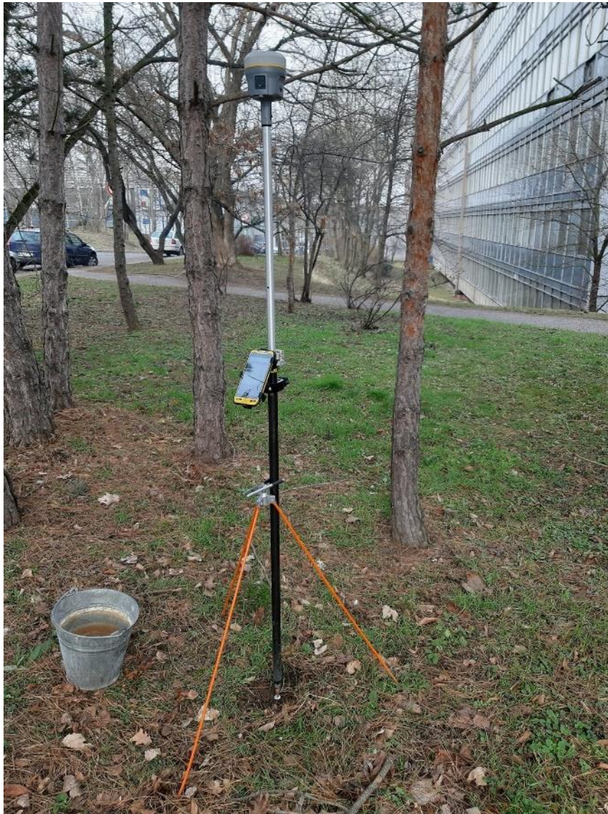
Obr. 8 GNSS přijímač Trimble R12i stabilizovaný ve stojánku na bodu 6
