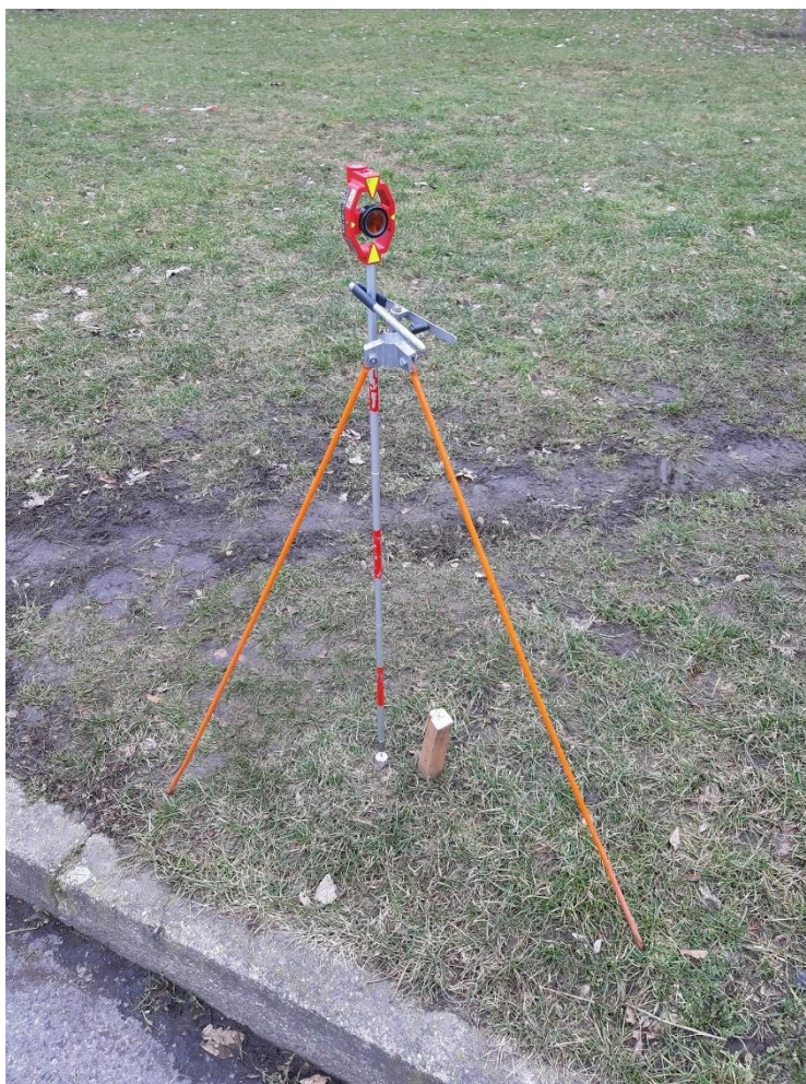
Obr. 5 Stabilizace minihranolu na bodech 1 až 6
