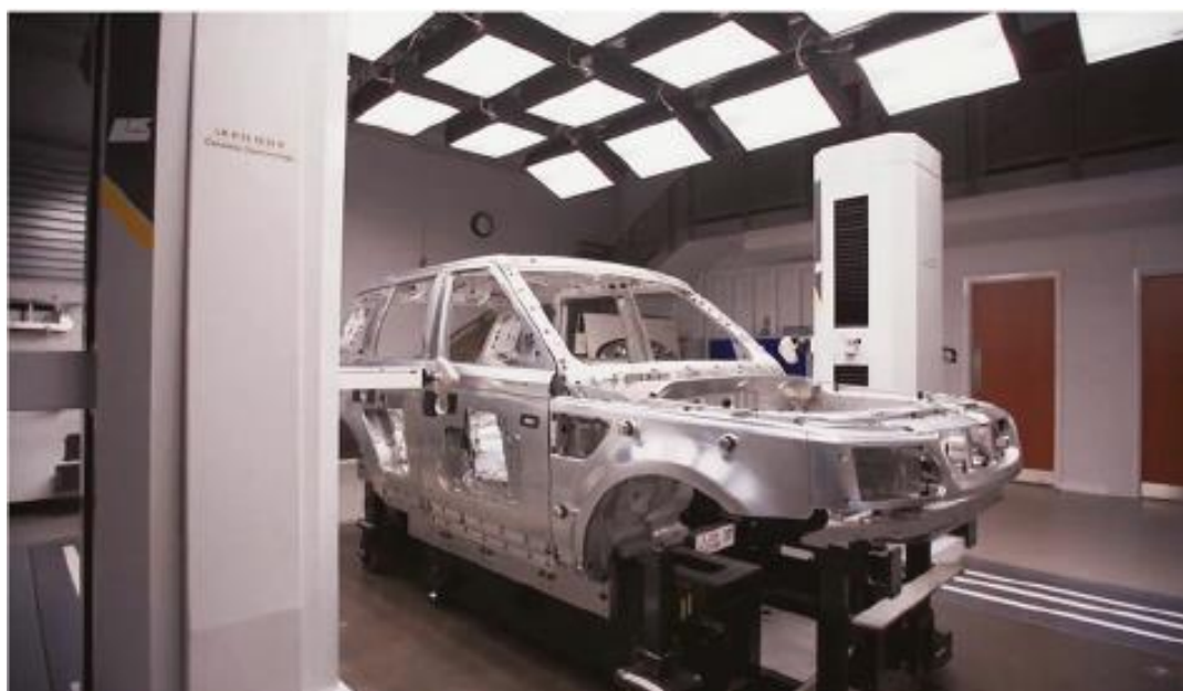
Obrázek 8 - Kontrola sřícování plechů na stojanovém CMM [29]
