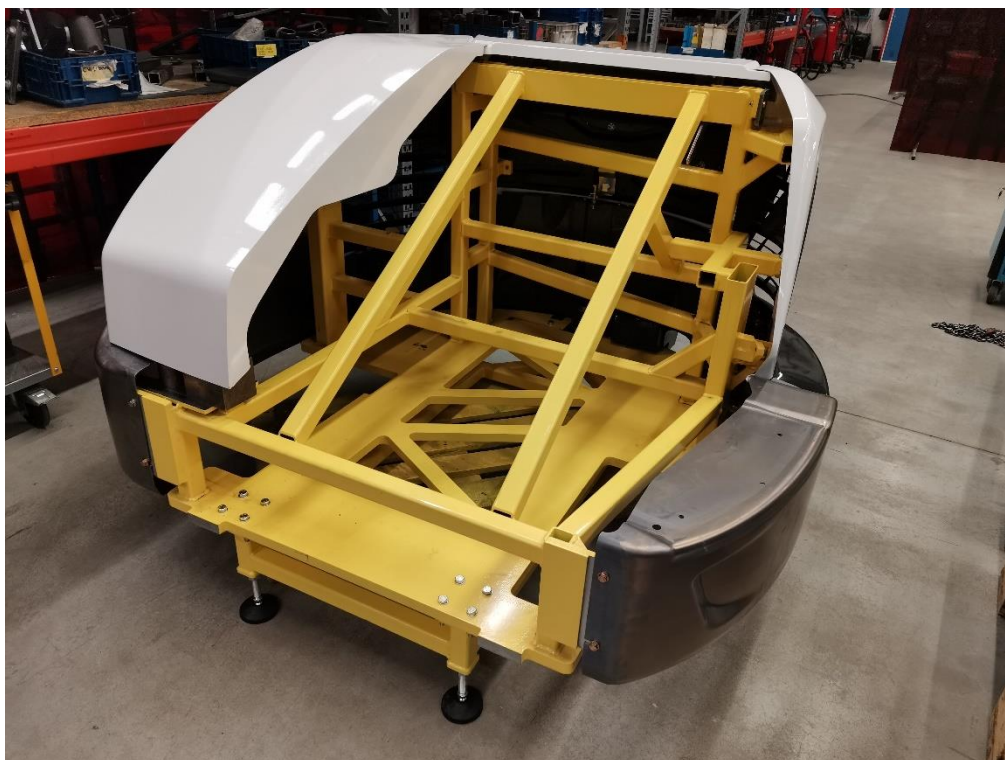
Obrázek 47 - Upínací přípravek osazený kryty mini rypadla
