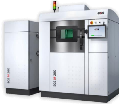
obr. č. 12: Tiskárna DMLS od firmy EOS model M290, cena se pohybuje okolo 700 000 USD
