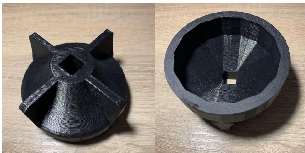
obr. č. 6: Vlastní výtisk nástrčného klíče na olejový filtr, FDM tiskárna Ender 3, materiál PLA, teplota hlavy: 215°C a podložky: 40°C, doba tisku zhruba 4 hodiny, výška vrstvy 0,24 mm.
