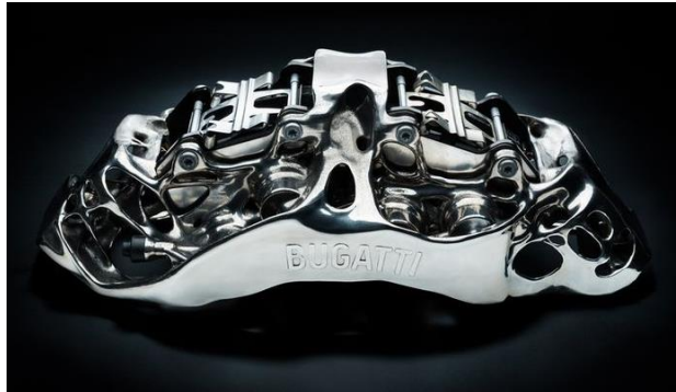
obr. č. 35: Brzdové třmeny z vozu Bugatti Chiron zhotovené technologií SLM z titanu
