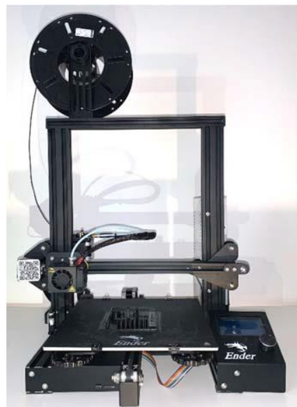
obr. č. 4: Tiskárna s uzavřeným pracovním prostorem od firmy Creality model CR5-5-pro obr. č. 5: Tiskárna s otevřeným pracovním prostorem od firmy Creality model Ender 3
