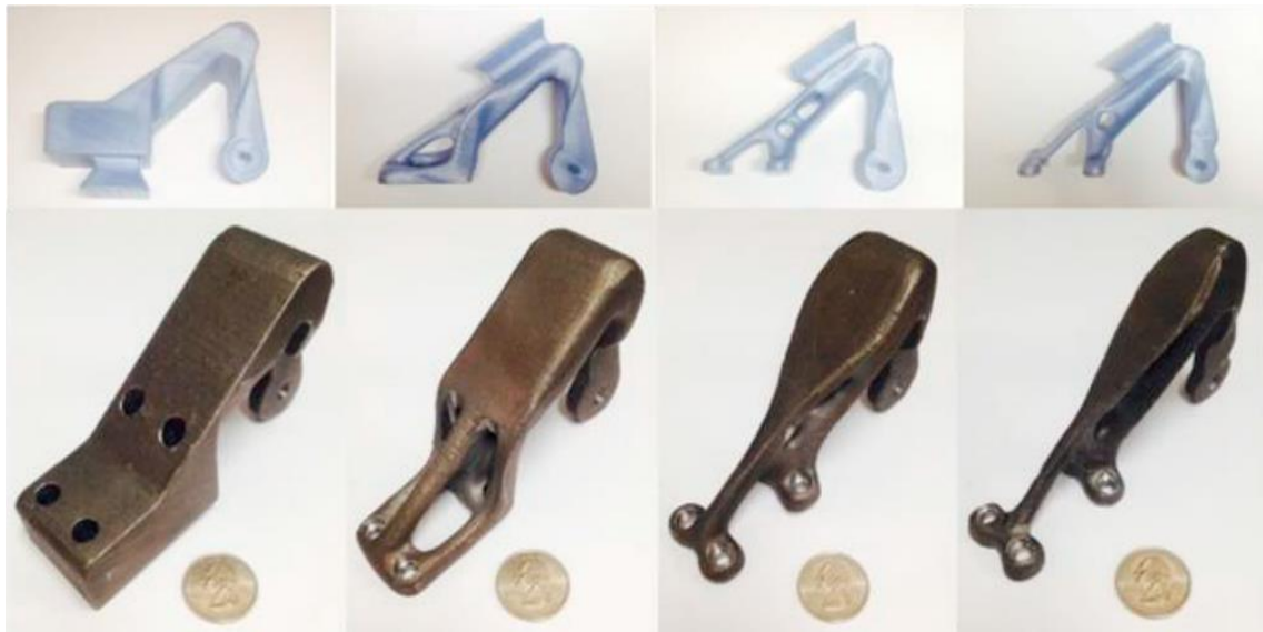
obr. č. 40: Ukázka odlitku litého na vytavitelný model s postupným provedením topologické optimalizace, vytavitelný model byl vytištěn z vosku pomocí technologie FDM
