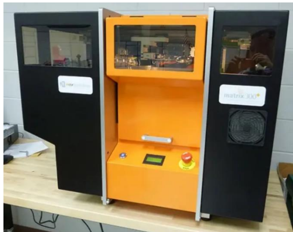
obr. č. 30 Tiskárna LOM od firmy Mcor model Matrix 300+, cena se pohybuje okolo 22 000 USD
