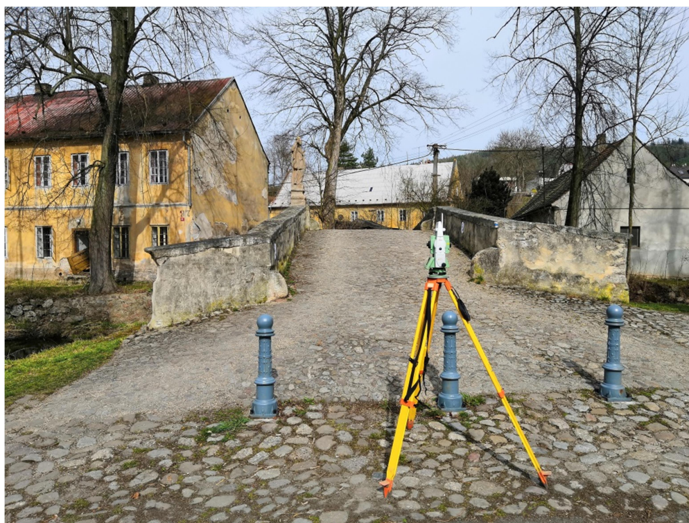
Obr. 20. Polární zaměření mostu v obci Dobřív
