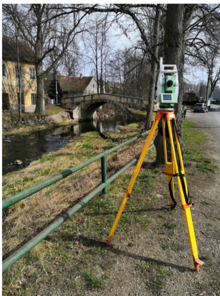
Obr. 10. Totální stanice Leica TS12 při měření v Dobřívě
