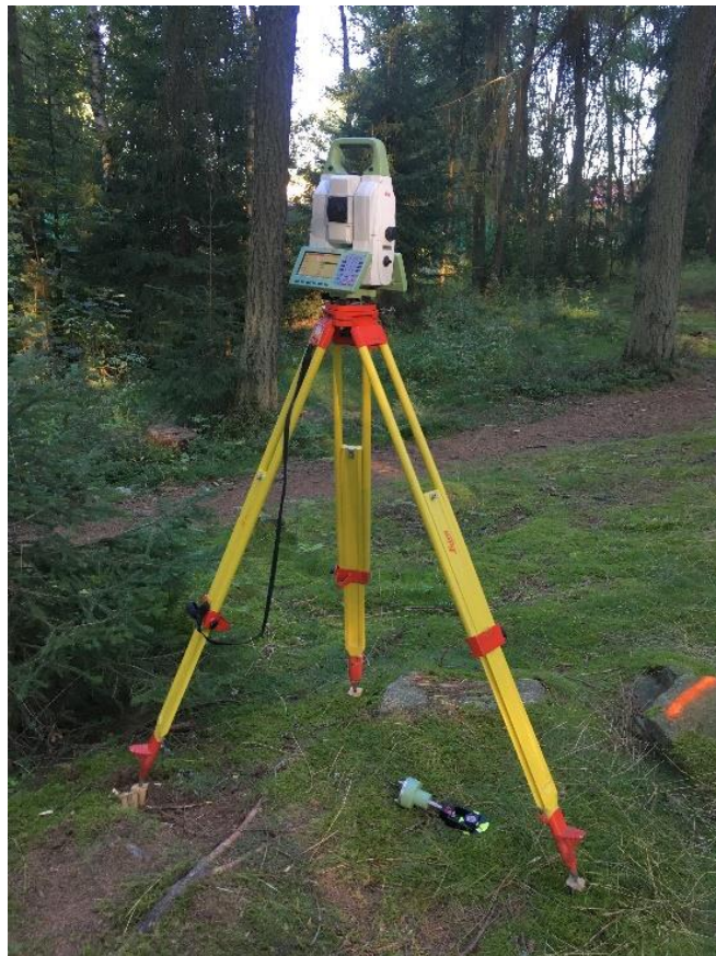
Obrázek 15 – TS Leica Nova MS60 na bodě č. 4003 [vlastní zpracování]
