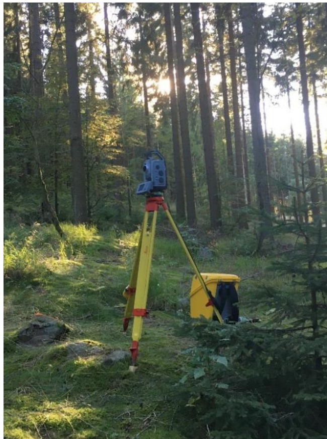
Obrázek 13 – TS Trimble S9 HP na bodě č. 4003 [vlastní zpracování]
