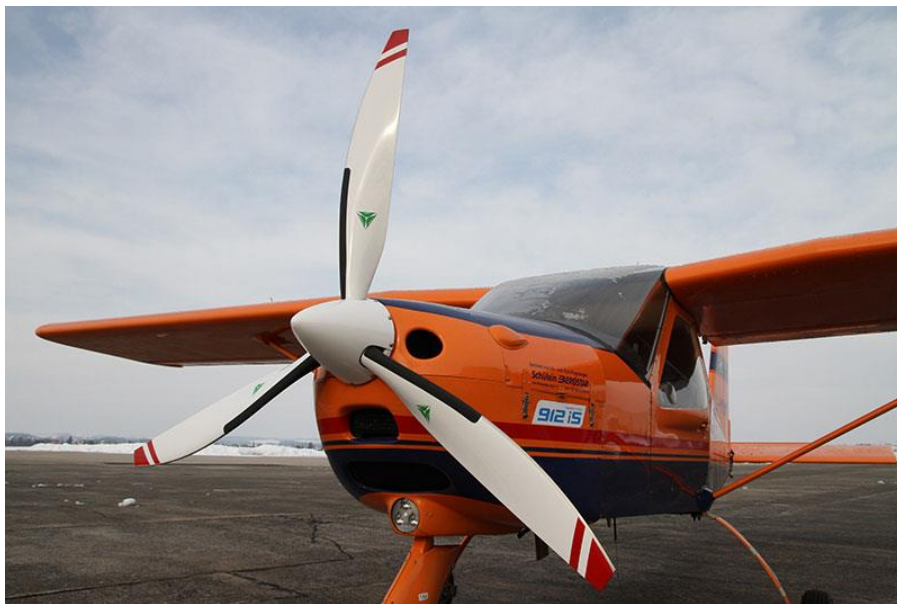
Obr. 9 Vrtule MTV-34-1-A/175-200 na letounu Tecnam P92 [13]
