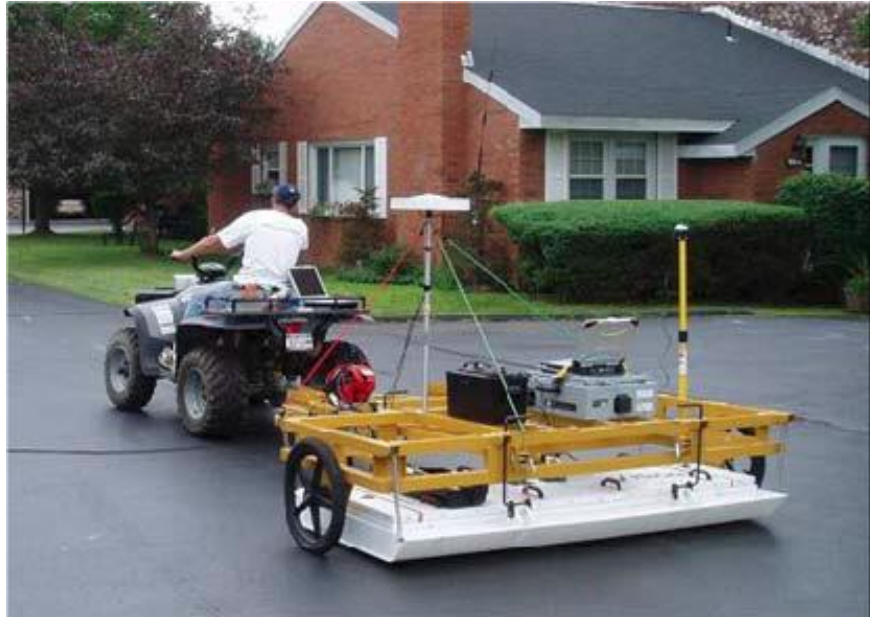
Obr. 14 Příklad testování funkčního prototypu multisenzorového detekčního zařízení, skládajícího se z elektromagnetických senzorů, georadaru a vibro-akustických senzorů, umožňujícího dokonalejší lokalizaci polohy vedení.
