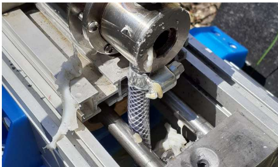
Obrázek 4.9: Zanesení trysky po testu zrna 17 [foto autor]
