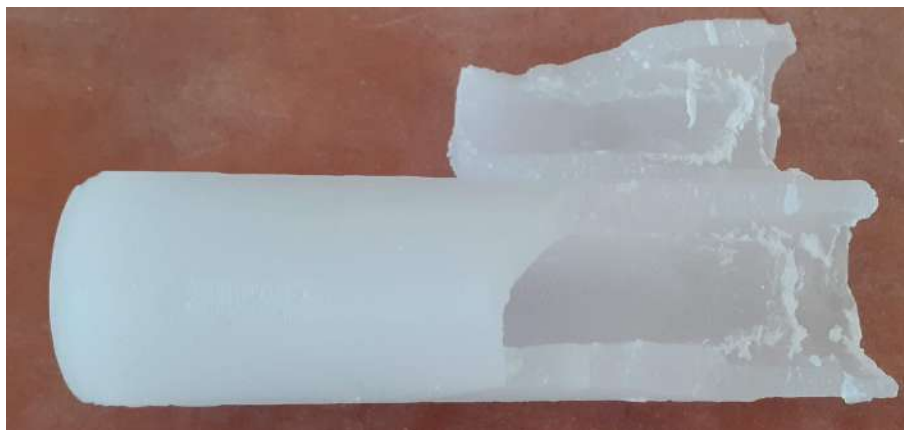
Obrázek 4.19: Rozlomené parafinové zrno [foto autor]
