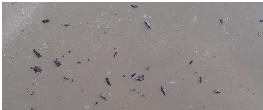
Obrázek 4.14: Zbytky po zrnech ASA [foto autor]
