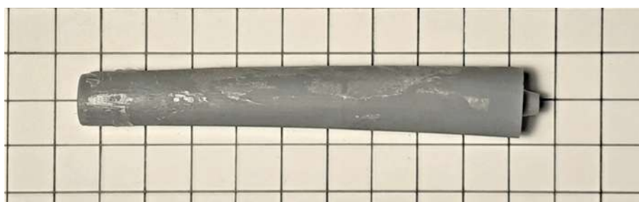
Obrázek 4.18: Jádro formy na odlévání parafinových zrn po provedení experimentu [foto autor]
