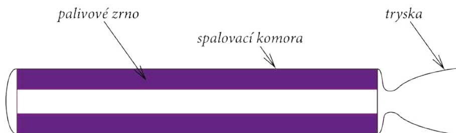
Obrázek 2.1: Schéma RM na tuhé palivo [27] [úprava autor]
