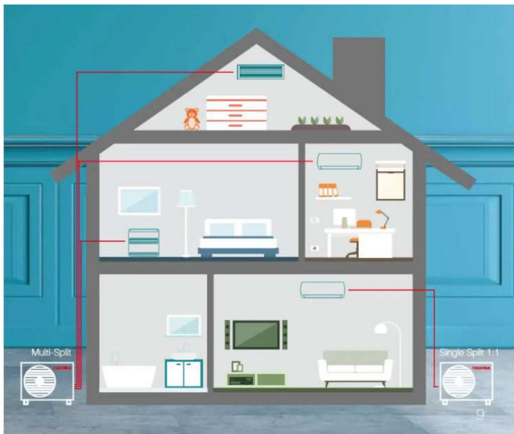
Obrázek 17: Schéma zapojení split systémů (M Klima s.r.o., nedatováno)
