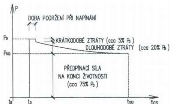
Obrázek 111 Schéma průběhu ztrát předpětí v čase [30]
