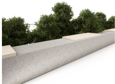
M01 Lavice podél záhonu Výška záhonu 40 cm, sedák z prken o rozměrech 150 x 50 x 5 cm. Materiály: pohledový beton, dřevo.
