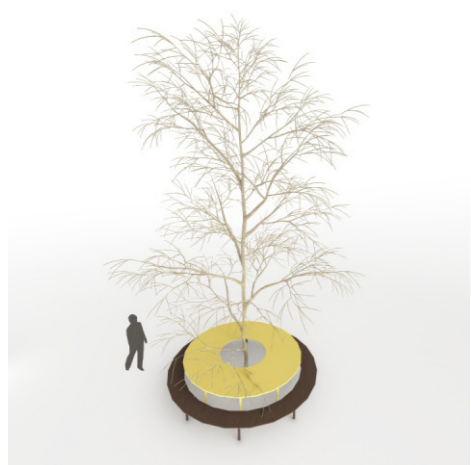
M04 Kruhová lavice velká M05 Kulatý stůl Vnější průměr 3,8 m, vnitřní 3 m, výška lavice 40 cm. Materiál: dřevo. Vnější průměr 3 m, vnitřní 1,2 m, výška stolu 85 cm. Barva žlutá, podobná RAL 1018. Materiál: dřevo.
