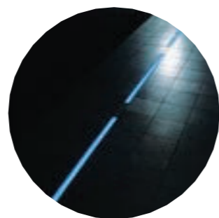
Pochozí led pásy O3 Doplňkové osvětlení pěších tras veřejného prostranství z pochozích LED pásků fugujících na solárním systému.
