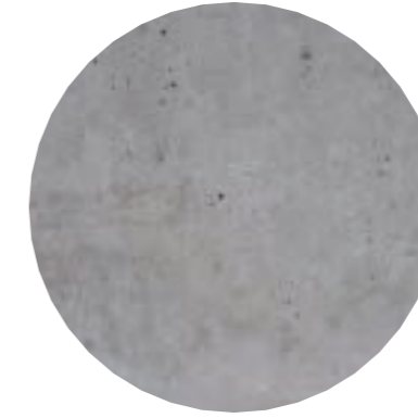
Pohledový beton (Bez označení) Pohledový beton bude použit na ostůvky ve vřejném prostranství, obrubníky, rampy a sklonité plochy tramvajových nástupišť.
