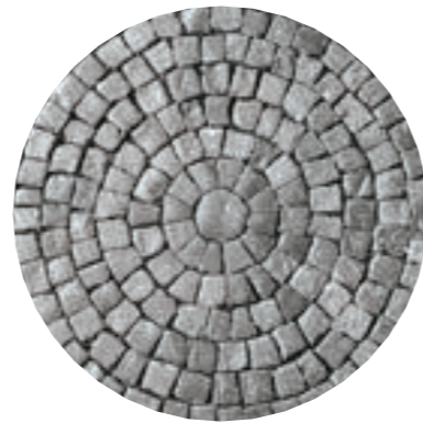
Velká žulová kostka (kroužek) P6 Velké žulové kostky použity ve své přírodní barvě. Dlážděny vlaštkou (viz. obrázek) do drceného kameniva drobné frakce. Tvoří pojízdné plochy zklidněných komunikací a příležitostného parkování.
