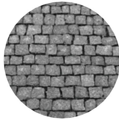
Velká žulová kostka (řádková) P5 Velké žulové kostky použity ve své přírodní barvě. Dlážděny řádkově (viz. obrázek) do drceného kameniva drobné frakce. Tvoří pojízdné plochy zklidněných komunikací a příležitostného parkování.
