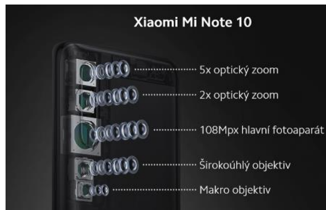
Obr. 21: Konfigurace objektivů na zadní straně smartphonu Xiaomi Mi Note 10 [22]
