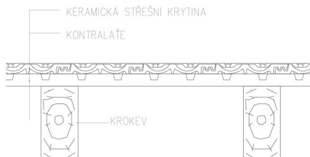
Obrázek 1.: Skladba střešní konstrukce
