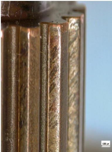
Obrázek 5-2 Detail na opotřebení evolventního drážkování
