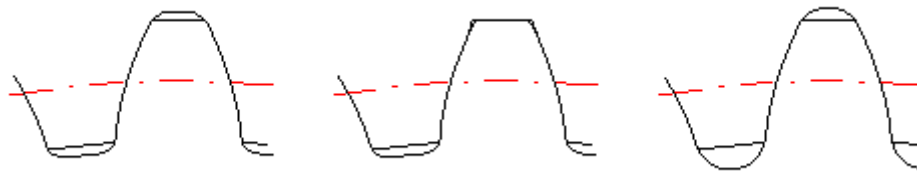
Obrázek 4-4 Středění na boky - rovná dna drážek, vnější středění, středění na boky - oblá dna drážek [ 10 ]
