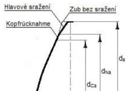
Obrázek 4-8 Příčná modifikace zubu [ 8 ]
