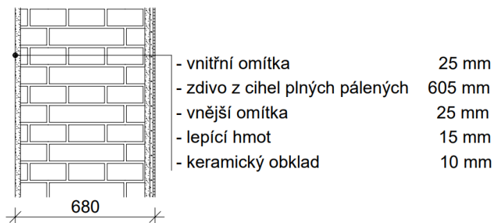
Obrázek 7 - Obvodová stěna nadzemní části objektu
