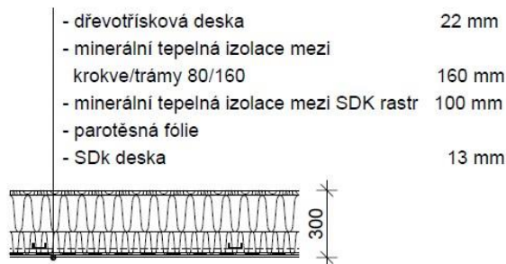
Obrázek 16 - Strop nad 3. nadzemním podlažím
