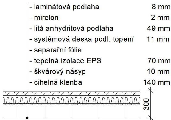
Obrázek 12 - Strop nad 1. podzemním podlažím
