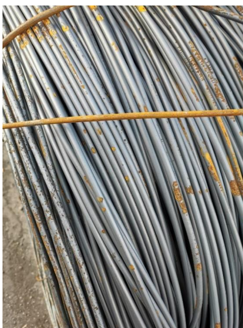
Obrázek 1 - Vstupní polotovar pro výrobu betonářské ocele. (Zdroj: Vlastní tvorba.)
