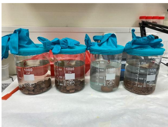
Obr. 19 Loužící se vzorky zakryté gumovými rukavicemi
