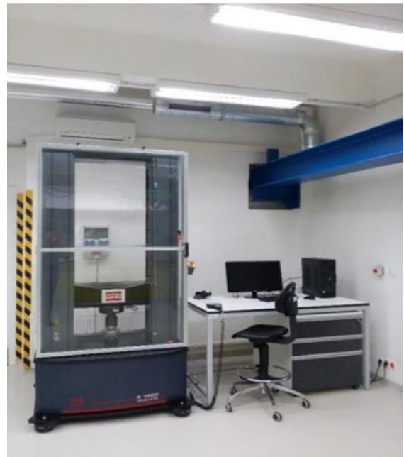
Obr. 13 Použitý mechanický lis MTS 300 exceed model E45
