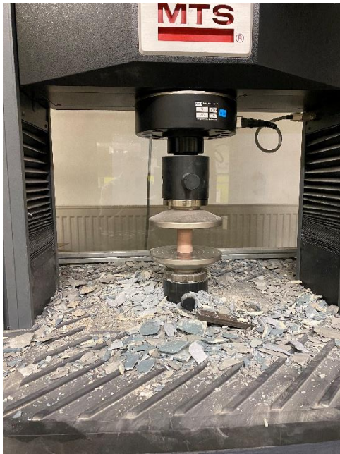
Obr. 12 Zkouška pevnosti v tlaku
