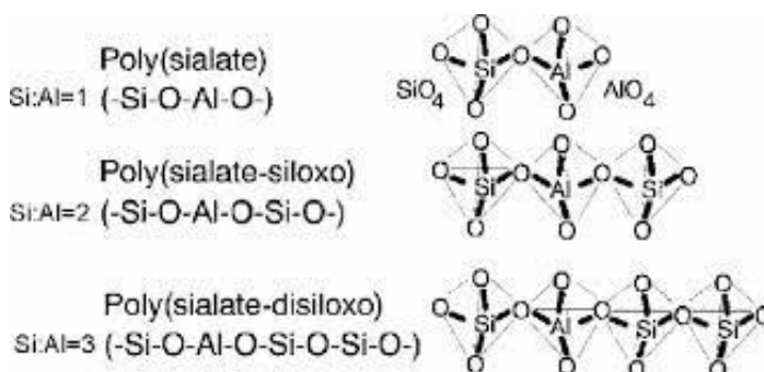
Obr. 7 Rozdělení geopolymery dle poměru Si/Al
