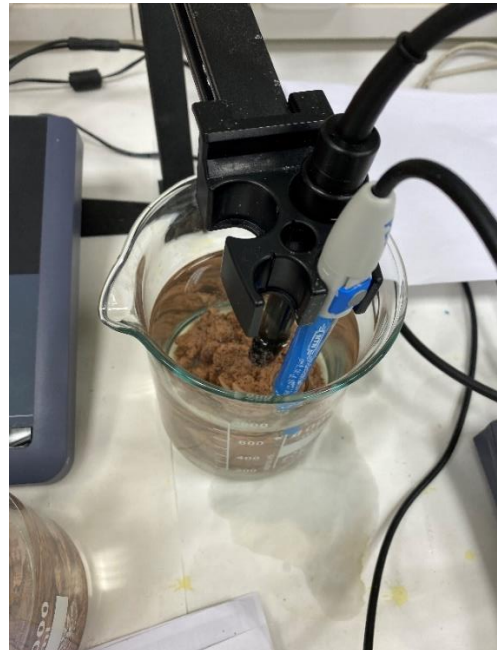
Obr. 11 Měření pH a konduktometrie vzorku s loadingem (3. týden)
