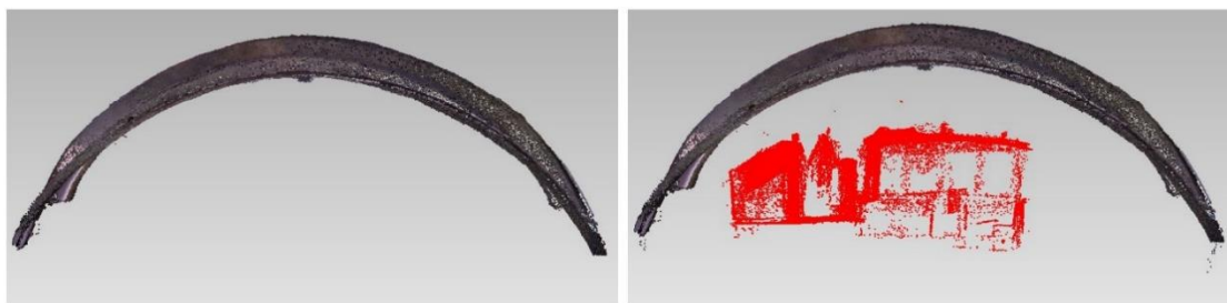
Obrázok 31: Odfiltrovanie nežiadúcich bodov. Vľavo Juditin oblúk po odfiltrovaní, vpravo (červenou) odfiltrované zhluky naskenovaných bodov [autor]
