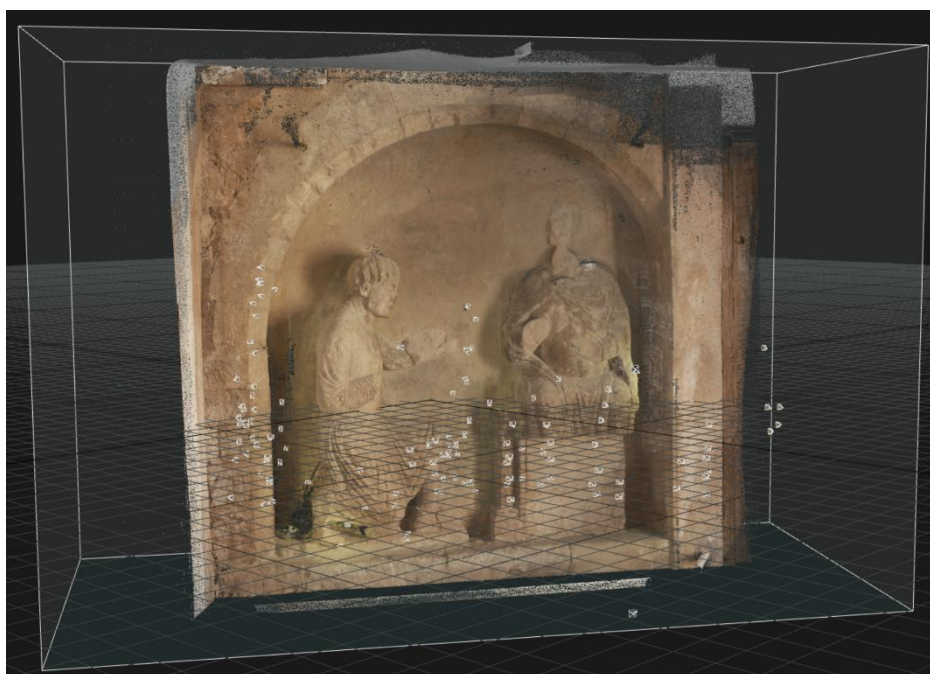
Obrázok 22: Reality Capture – model vytvorený kombináciou metód laserového skenovania a fotogrametrie [autor]
