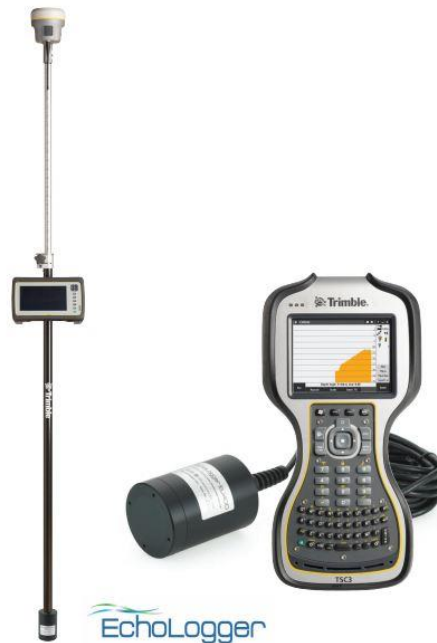
Obrázok 41: Dostupné zariadenie Echologger EU400 pripojené k GNSS Trimble
