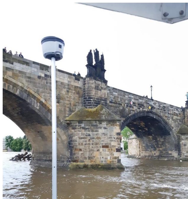
Obrázok 50: GNSS aparatúra Trimble R2 pri prieskume Juditinho mosta [autor]
