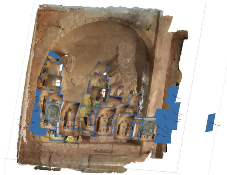
Obrázok 18: Metashape – 3D model reliéfu s náhľadom na polohu obstarania snímok [autor]
