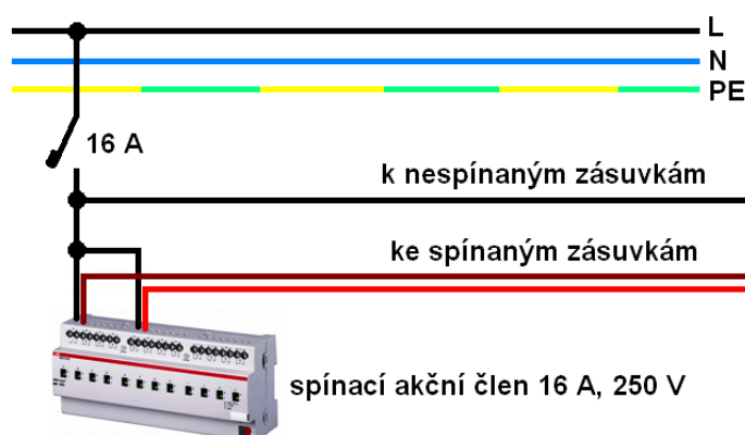
Obr. 3.9: Zapojení zásuvkových obvodů se sběrnici KNX [8]
