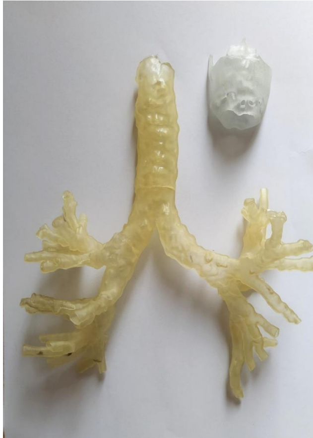
Obrázek 10 - Vyrobený model dýchacích cest a hrtanu
