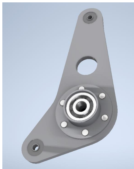
Obrázek 42.: Páka 2 příčného řízení
