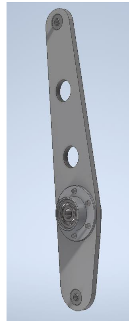
Obrázek 44.: Páka podélného řízení
