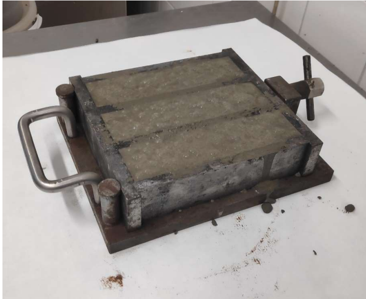
Obr. č.4 Zhutněné vzorky na vibračním stolku
