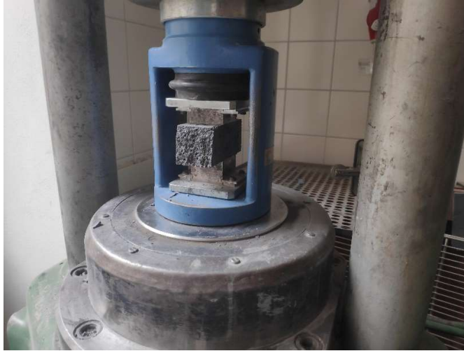
Obr. č.5 Zkoušení pevnosti v tlaku
