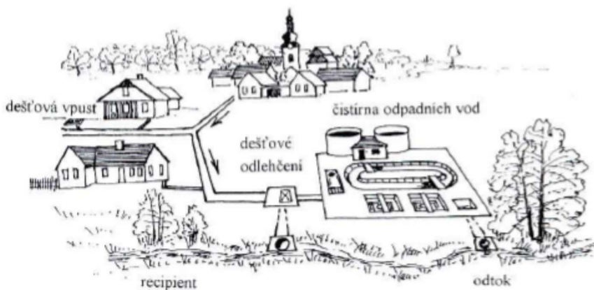
Obr. 6 - Schéma centralizovaného odvádění odpadních vod [22]
