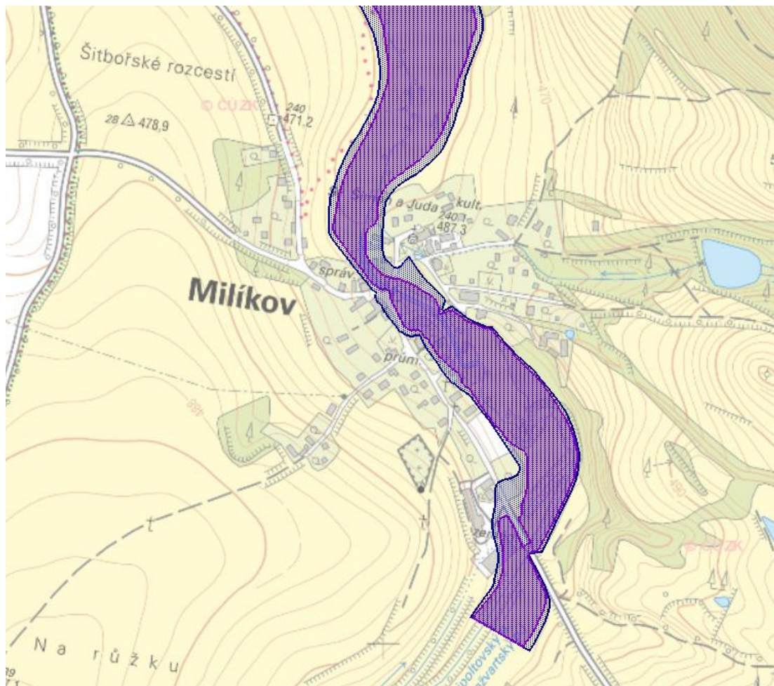
Obrázek 17: Aktivní záplavová zóna Q_{100} (fialově) a záplavové území Q_{100} (modře) Lipoltovského potoka v řešeném území [44]
