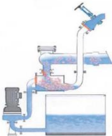
Obrázek 7: Fáze přítoku přes separátor pevných částic [15]
