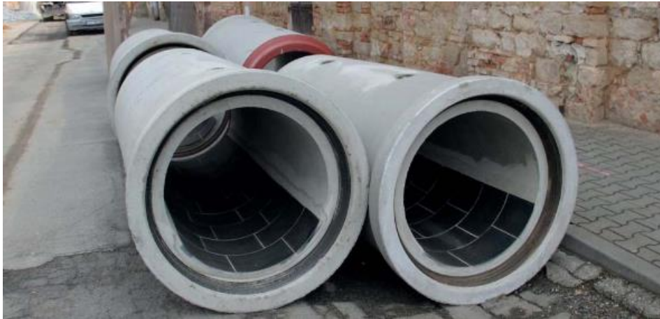
Obrázek 9: Ukázka betonových prefabrikovaných trub opatřených vystýlkou z čedičové dlažby [20]
