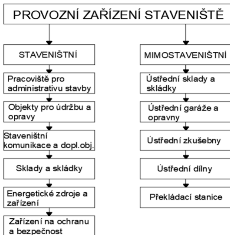
Obrázek 2 - Schéma provozního zařízení staveniště (1)
