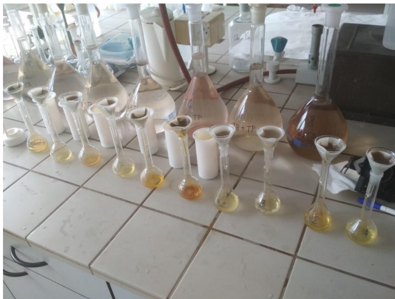
Obrázek 4: Filtrace vzorků po dokončení rozkladu dle EPA 3052, autor Lenka Langhammerová, 13. 4. 2021
