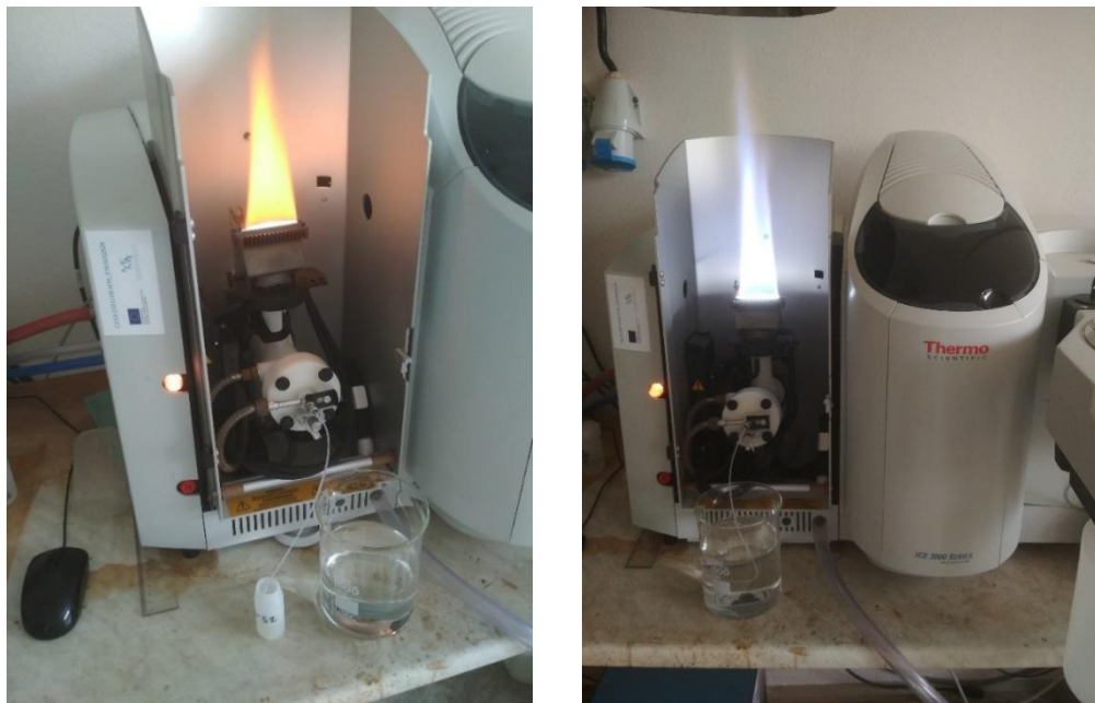
Obrázek 5.I a 5.II: FAAS analýza vzorku, vlevo palivo vzduch a acetylen vpravo oxid dusný a acetylen, autor Lenka Langhammerová, 4. 5. 2021
