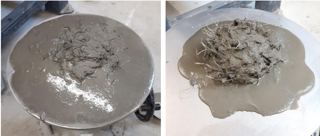
Použité množství vláken 2 kg/m 3 (levý obrázek), použité množství vláken 11 kg/m 3 (pravý obrázek)
