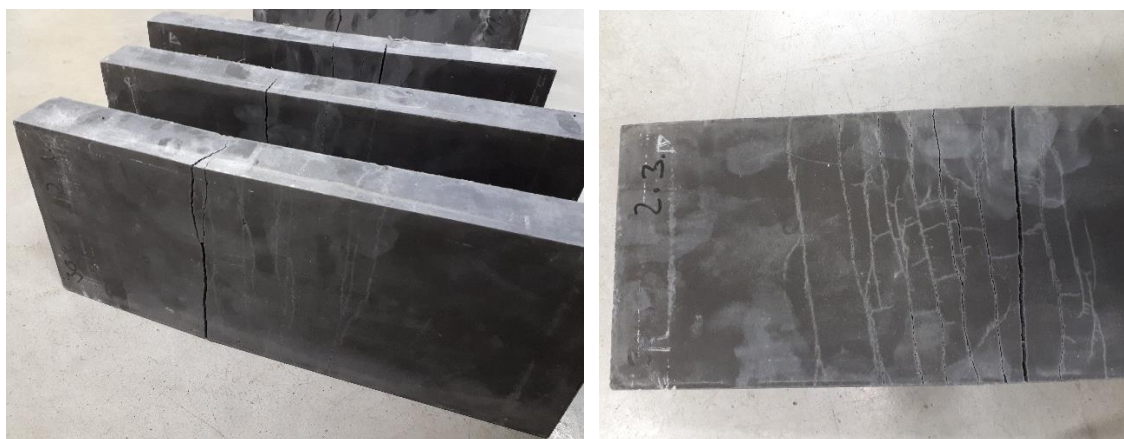
sada porušených vzorků (levý obrázek), viditelné mikrotrhliny na porušeném vzorku (pravý obrázek)
