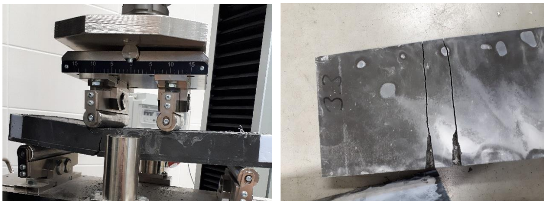
pohled na porušený vzorek při maximálním zatížení (levý obrázek), absence mikrotrhlin po porušení (pravý obrázek)
