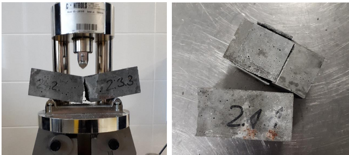
Vzorek po zkoušce v tahu za ohybu (levý obrázek), vzorek po odzkoušení tlakem (pravý obrázek)
