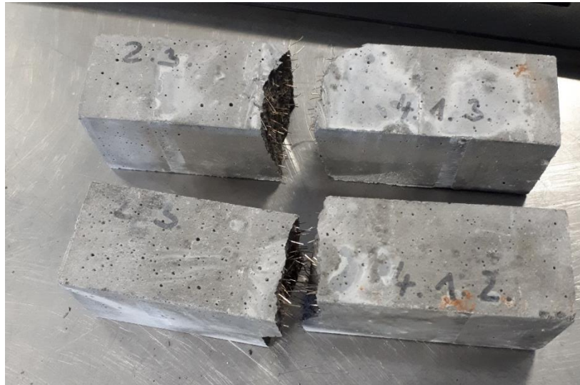
Obrázek 4.12: Úlomky trámečků po zkoušce v tahu za ohybu MF 482
