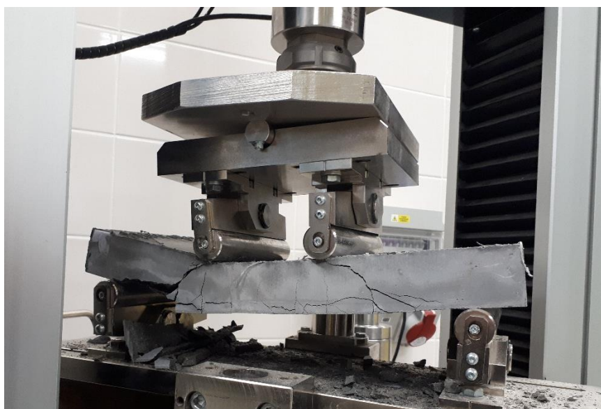
Obrázek 5.21: Smykem porušený prvek MF 230 s rozvojem trhlín v oblasti pracovní spáry
