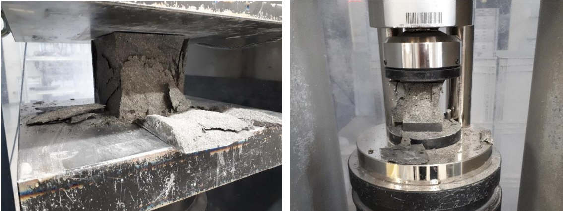
Krychle z prostého betonu po odzkoušení (levý obrázek), trámeček po odzkoušení (pravý obrázek)
