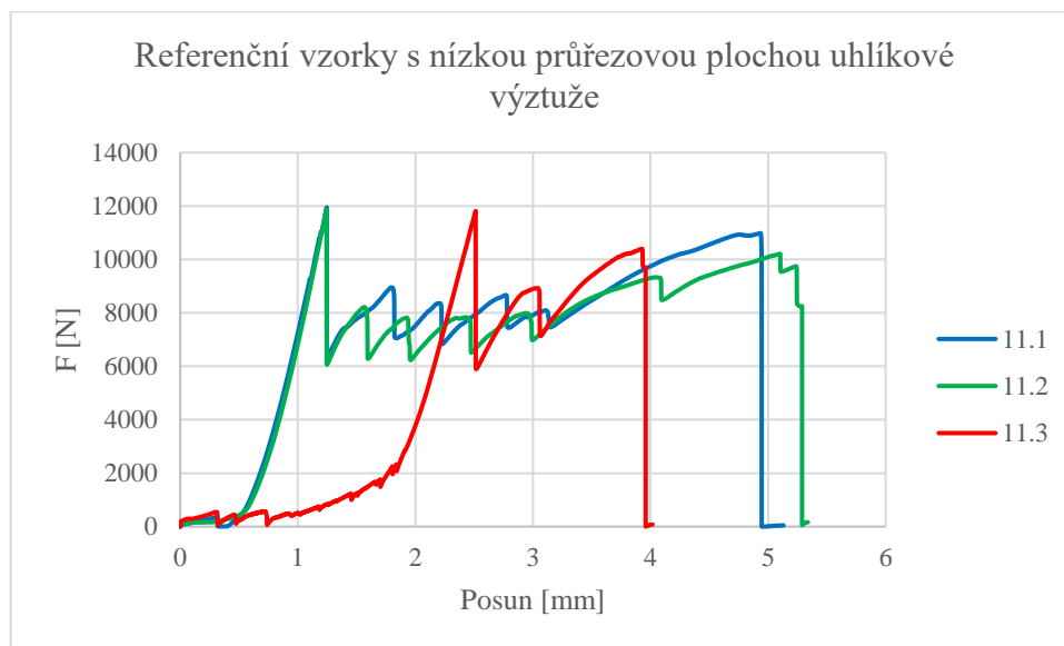
Obrázek 5.4: Graf závislosti síly na posunu pro slabě vyztužené referenční vzorky
