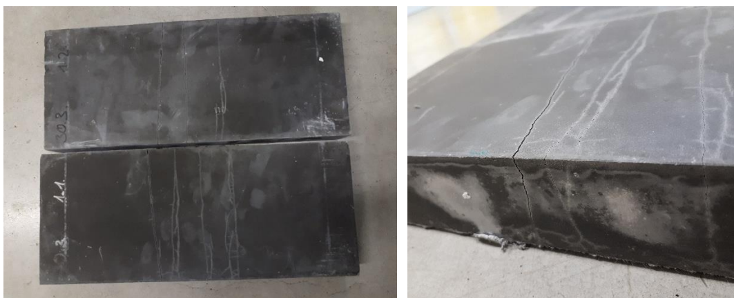
Obrázek 5.7: Způsob porušení MF 012 slabě vyztužených prvků
