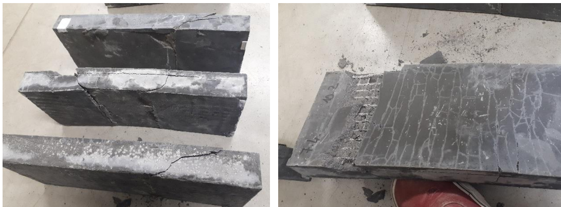
sada vzorků porušených smykem (levý obrázek), delaminace na porušeném vzorku (pravý obrázek)
